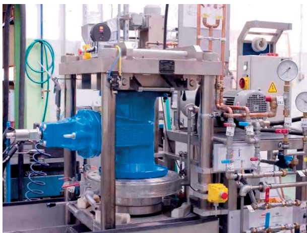
Рис. 1 Тестирование задвижек AEON
